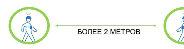
Носимые приборы постоянно измеряют расстояние между собой. При сближении устройства издают звуковой сигнал, оповещающий сотрудников о необходимости разойтись на безопасное расстояние
